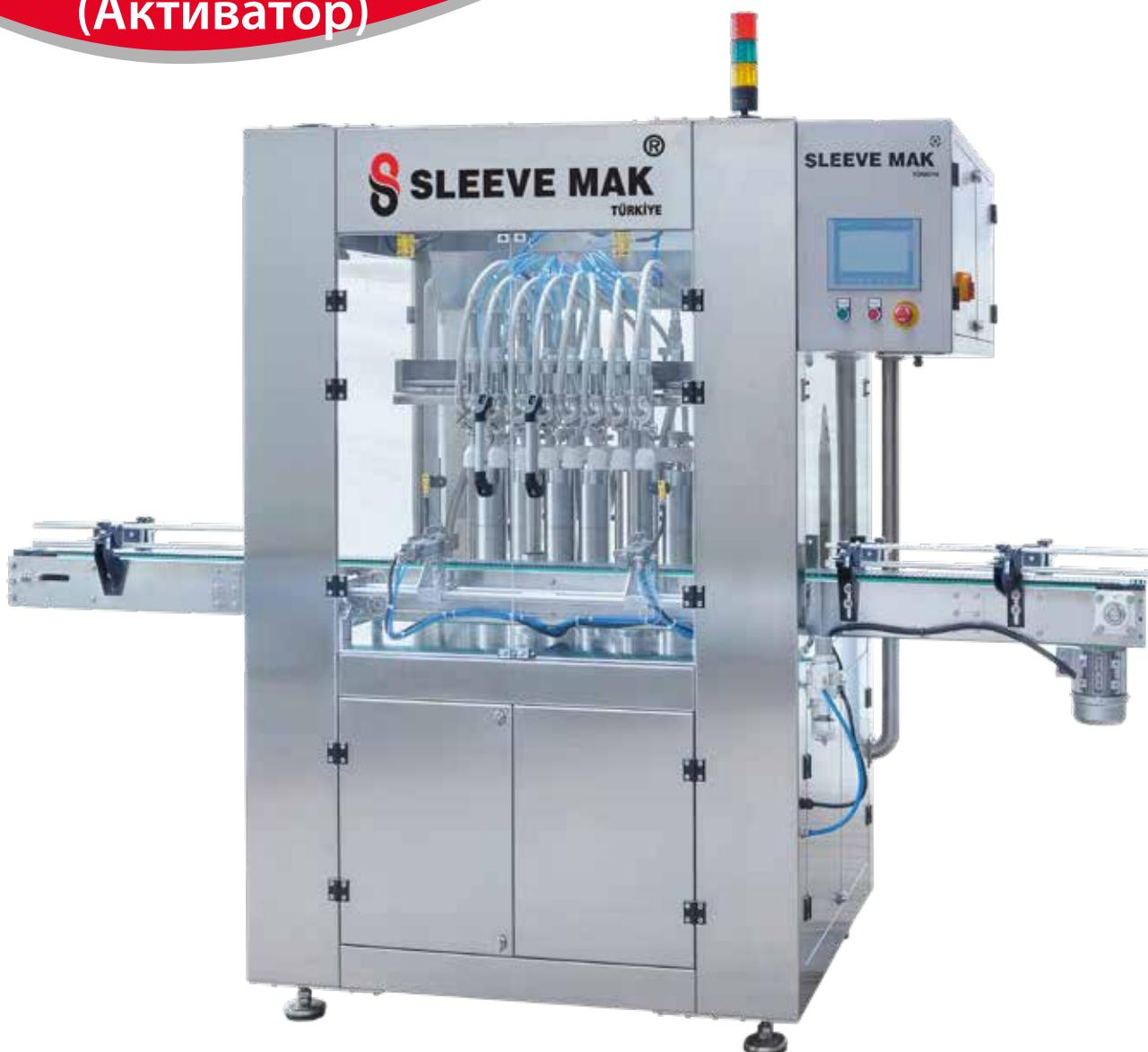
Машинам для наполнения жидкостью с 8 форсунками (SVM-FLA008)
